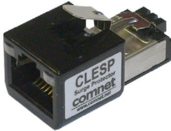
El CLESP de ComNet™ CopperLine® proporciona sobretensión muy eficaz y protección transitoria para equipo de compatibilidad de Ethernet, incluyendo conmutadores Ethernet, convertidores de medios, módems EoVDSL, ComNet CopperLine Ethernet sobre extensores de transmisión UTP, etc. El conector de acoplamiento RJ-45 en el CLESP enchufa directamente en cualquier Puerto Ethernet 10/100/1000 BaseT, lo cual hace simple y rápida la instalación.
