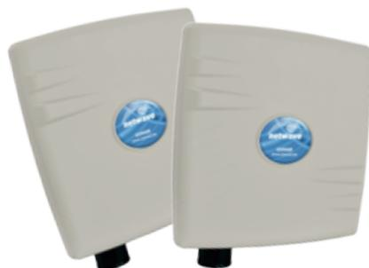
Le NWK2/M est un kit de transmission point-à-point de la gamme industrielle. Ce kit inclut le Client et le Point d'Accès. Il supporte une bande passante de 95Mbps utilisant la technologie MIMO. Les bornes peuvent être alimentées en PoE (802.3af) ou via un injecteur qui est inclus avec le kit. Le NWK2/M est certifié ETSI, DFS et TPC pour un usage partout dans l'UE.
