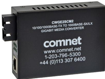
Les convertisseurs de média Ethernet CWGE2SC(M,S)2 de ComNet™ sont conçus pour transmettre et recevoir 10/100/1000 Mbps de données sur fibre optique multimode ou monomode. L'interface Ethernet négociera automatiquement 10, 100 ou 1000 Mbps sans aucun réglage. L'interface optique fonctionne à 1000 Mbps. Ces convertisseurs de média sont destinés à un usage industriel léger.
